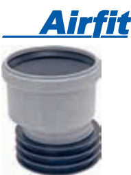
Airfit Steckmuffe Plus DN 110x110 exzentrisch PP exzentrisch für dickwandige Rohre für Innen-Ø 100 – 150 mm Versatz 7,4 mm DN: 110 Material: Kunststoff PP Norm: Brandverhalten: geprüft nach DIN 4102-B2 EN 13501-1-E, EN 11925-2 geprüft und zugelassen: Z-42.1-394
