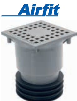
Bodenablauf universal ,Profi‘ höhenverstellbar und drehbar, durch Herausziehen des Siphoneinsatzes ergibt sich eine Reinigungsöffnung, Lamellen-Dichtung abnehmbar DN: 110 Material: Kunststoff PP, schlagfest
